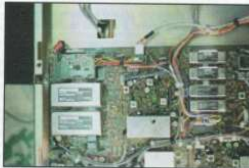
Foto della main board dell'IC-765 con l'installazione della scheda + cavo schermato del VOICE
