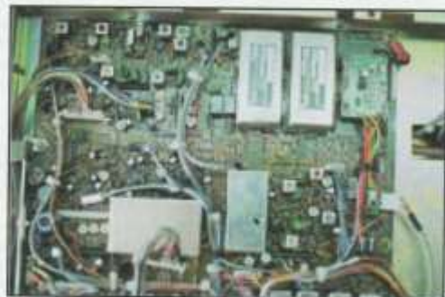
Foto della main board dell'IC-765 dove viene sostituito il condensatore con il cavetto schermato della scheda DSP (in/out)
